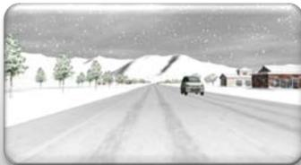
路面シミュレーション: 場所と気象による路面・タイヤ摩擦モデル
