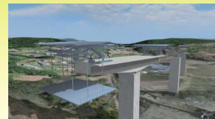
橋桁の架設の流れを表現したシミュレーション。設計のCADデータから変換した3Dモデルに可動設定を追加し張出し架設工法で桁が架設される流れを施工機械の動きと共に表現している他、PC鋼材等の配置確認も可能なCIM対応のデータとなっている。完成形では周辺からの景観確認やドライバー視点での視認確認を行っている。
