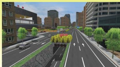
中国西部シルクロードの通り道、蘭州大型鉄道設計での応用で、ドライビングシミュレータと連携しながら、実験を行っている。キーポイント(1)大型3D交通設備空間レイアウト配置の合理性(2)複雑な交通環境の下で、運転手反応効率性の再現。この業務は、大型なプロジェクトの推進を支えられる技術サポートを提供した。
