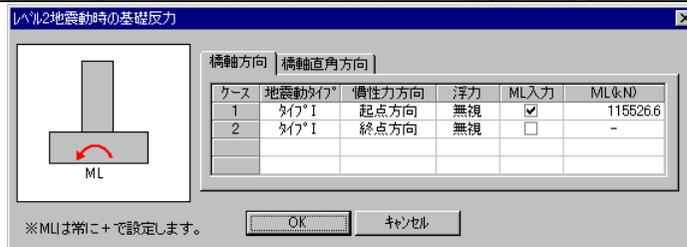
適用道路橋示方書が平成14年3月の場合の、レベル2地震動時のフーチングの照査を行う時に用いる、基礎反力(直接基礎)を設定します。
