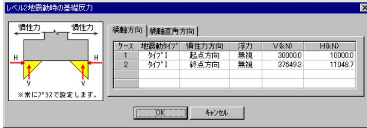
適用道路橋示方書が平成8年12月の場合の、レベル2地震動時のフーチングの照査を行う時に用いる、基礎反力(直接基礎)を設定します。
